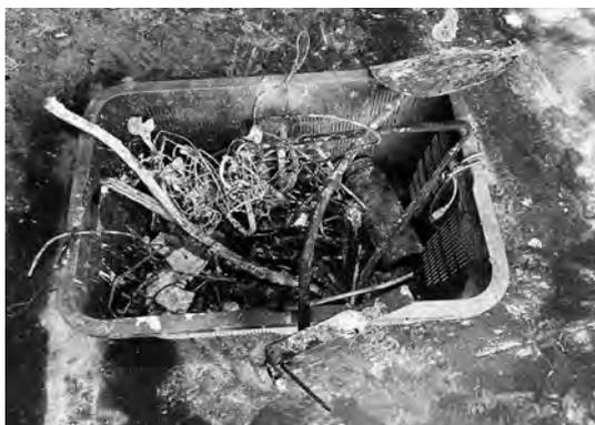
焼却炉の灰から出てきた金属類
