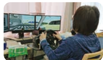
両上肢だけでも運転ができるドライブシミュレーター
