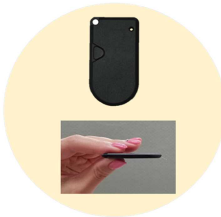
実験で使用するBLEビーコン
