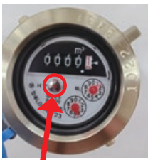
蛇口を閉めても、この部分（パイロット）が回っている場合は漏水です。
