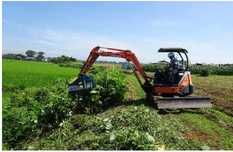
【時期】 5月・6月・7月・8月 【内容】 活動計画に基づき大型草刈機・刈払機による農道・水路・法面等の除草を実施した。
