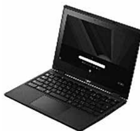
液晶ディスプレイが360°回転し、ノートPCにもタブレットにもなる
