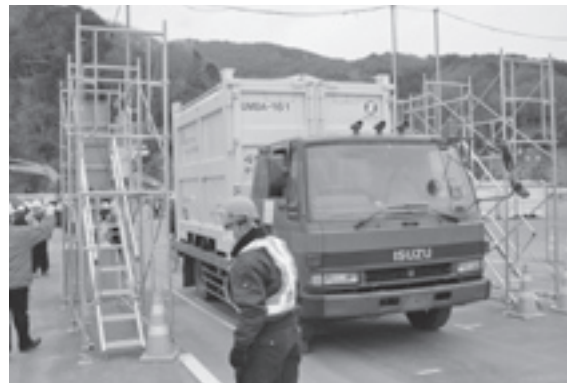
コンテナ積載後の放射能測定
