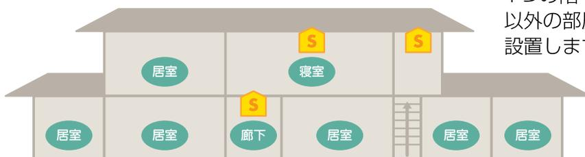
1つの階(例図1階)に居室(7㎡以上の寝室以外の部屋)が5以上ある場合は、**廊下**にも設置します。
