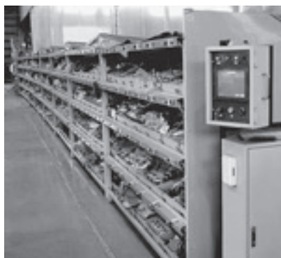
ピッキングシステム
