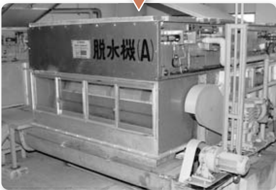
分離された汚泥は脱水されて乾燥焼却設備に送られ、一部は有機肥料として有効利用されます。
