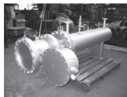
①電気式ヒーター
