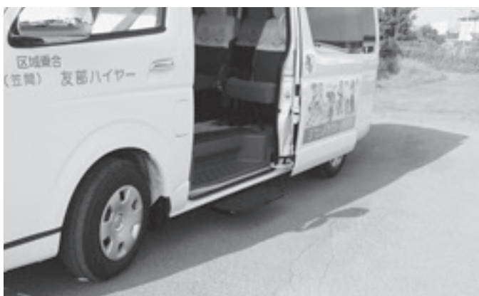
ステップ設置により乗降時の段差が改善
