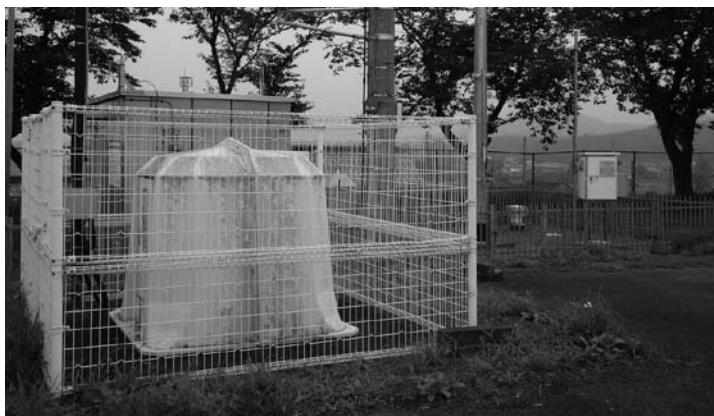
笠間支所に設置されている震度計と雨量計（右奥）
