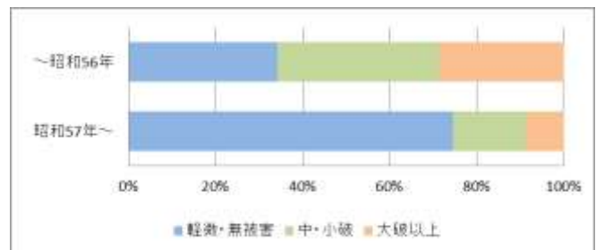
阪神・淡路大震災の建築物被害(新耐震基準導入前後比較)
